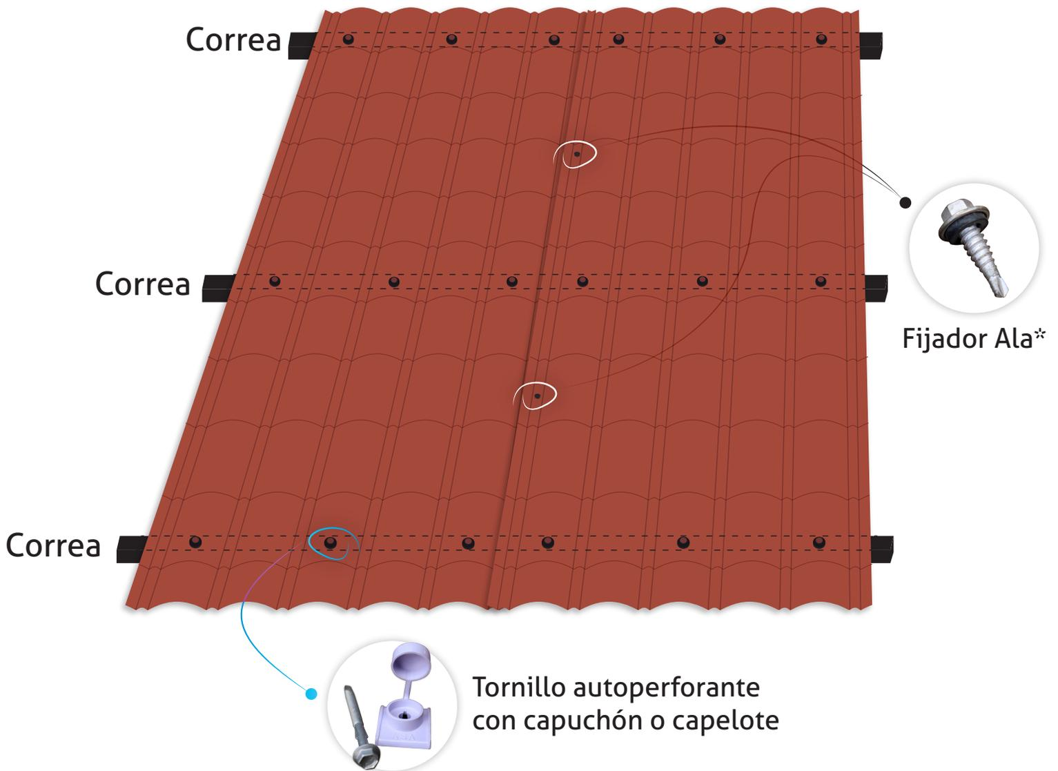
**\*Fijador Ala:** Le da resistencia mecánica al traslape longitudinal de la teja. Evita que el viento cruzado ingrese al interior y se pueda dañar la teja. Evita filtraciones de agua pues une más el traslape. Siempre debe utilizarse por asegurar los caballetes, las solapas, los remates y la limatesa a la teja únicamente.
